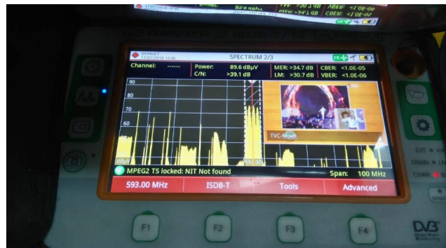
Figura 3.16: Imagen de la toma de mediciones del transmisor.
