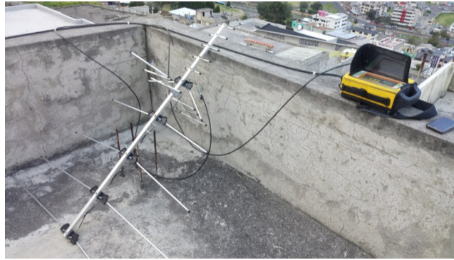
Figura 3.23: Mediciones del MER con una antena casera.
