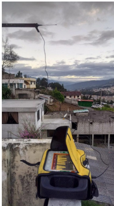
Figura 3.22: Mediciones del MER con una antena digital.
