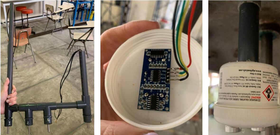
En la *Figura 10*, se muestra la instalación del sensor de nivel HC-SR04.
